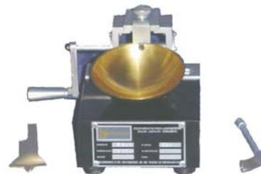
**ESPECIFICAÇÃO****APARELHO CASAGRANDE, ELÉTRICO
