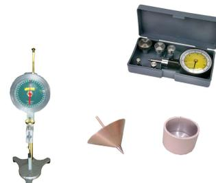
**ESPECIFICAÇÃO****PENETRÔMETRO DE CONE P/SOLOS (LIMITE DE LIQUIDEZ)**
