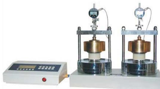
**ESPECIFICAÇÃO****PRENSA DE ADENSAMENTO PARA 3 ENSAIOS SIMULTÂNEOS**
