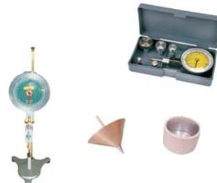
**ESPECIFICAÇÃO****PENETRÔMETRO DE CONE P/SOLOS (LIMITE DE LIQUIDEZ)**
